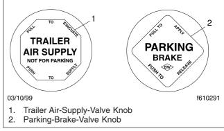
Fig. 12.2, Brake Valve Knobs
