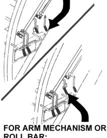
FOR ARM MECHANISM OR ROLL BAR: PULL LEVER TO RAISE CONTAINER. PUSH LEVER TO LOWER CONTAINER
